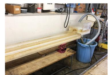
デイスポージャーの下水施設への影響を調べるための、下水管路模型。
