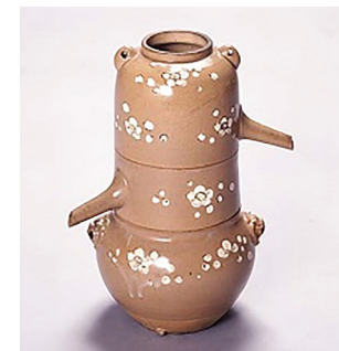
江戸時代に使われていた蒸留器「蘭引」。水・いばらの花・水と重ねて蒸留水を抽出します。
